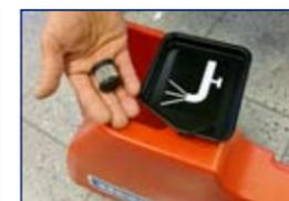
Filter von Frischwassertank reinigen
