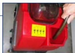
Frischwassertank füllen, Reinigungsprodukt dazugeben
