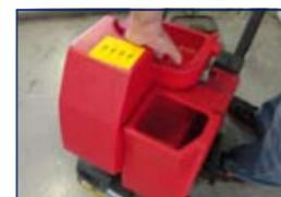
Schmutzwassertank und Frischwassertank entfernen, entleeren und gründlich spülen
